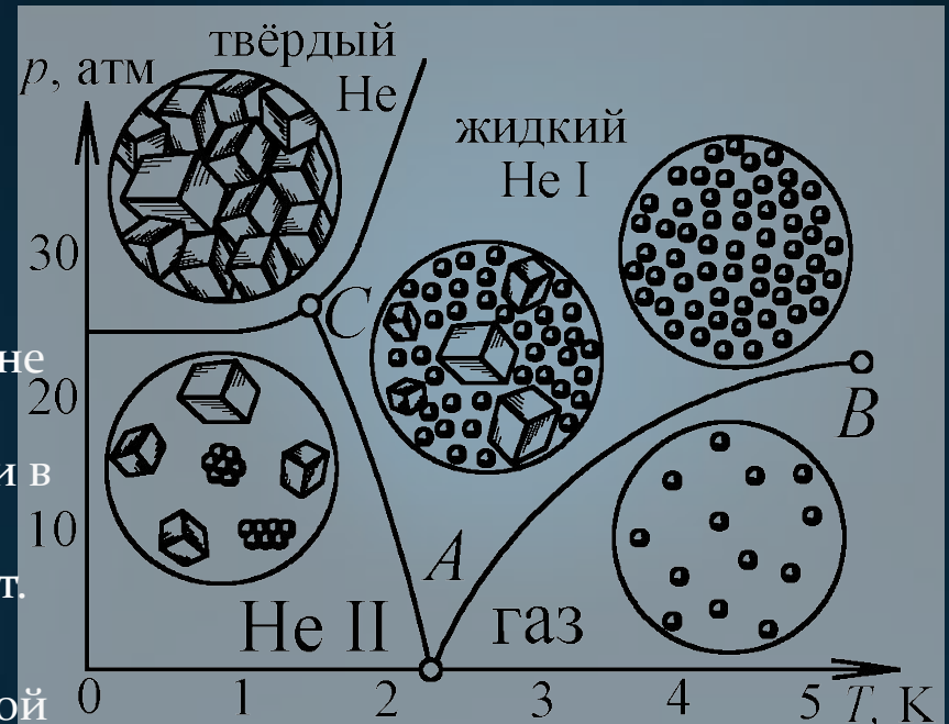
Рис.4. В зависимости от давления и температуры микрористаллы, вырастающие в жидком гелии, либо отдаляются, образуя "газовую" фазу, либо смерзаются в единую "снежную" массу гелия.
