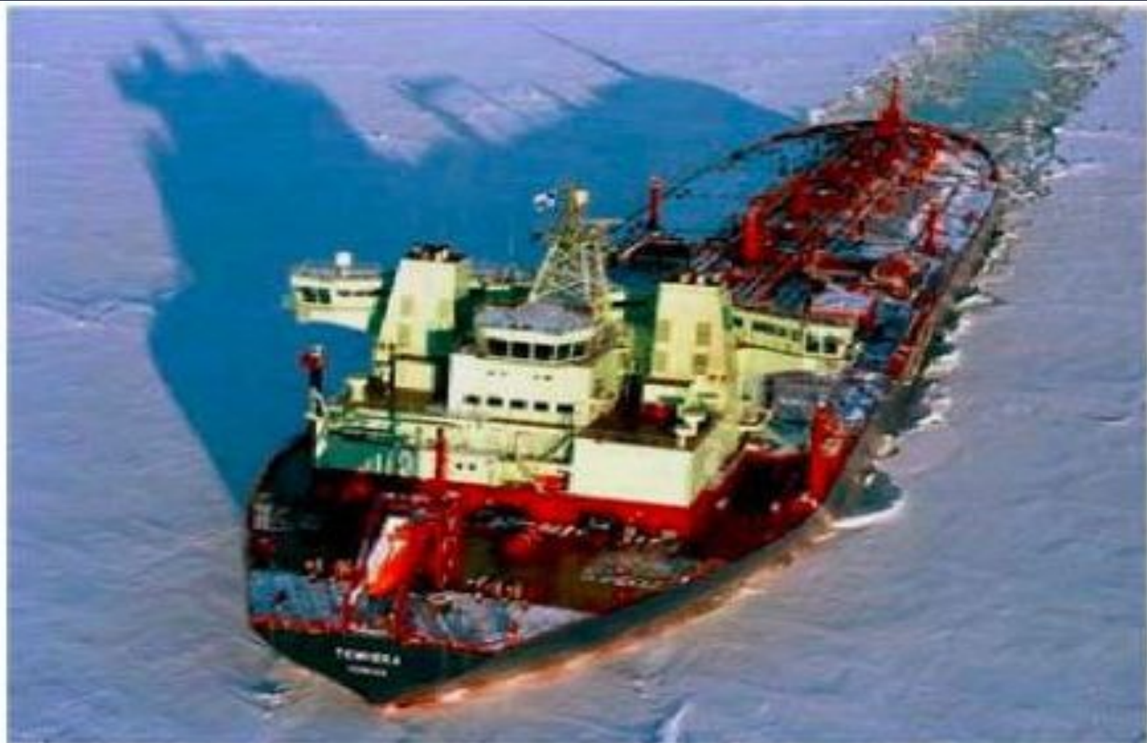
Рис. 6.7. Танкер двойного действия – Double Acting Tanker (DAT) TEMPERA
