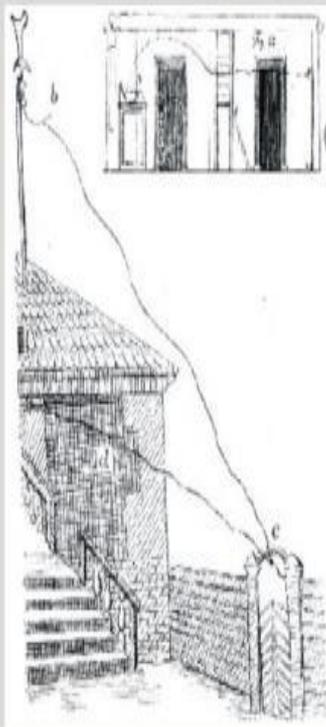
Прообраз электроскопа «указатель электрический». Проводник соединял линейку с железным прутком на крыше, притягивавшим атмосферное электричество.
