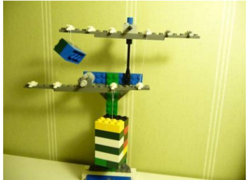
2 детали ЛЕГО, привязанные к длинному плечу первого рычага, мне удалось уравновесить 12 такими же деталями, привязанными к короткому плечу второго рычага. Значит, моя система рычагов увеличивает силу в 6 раз, что равно **произведению передаточных отношений рычагов**, а не сумме.
