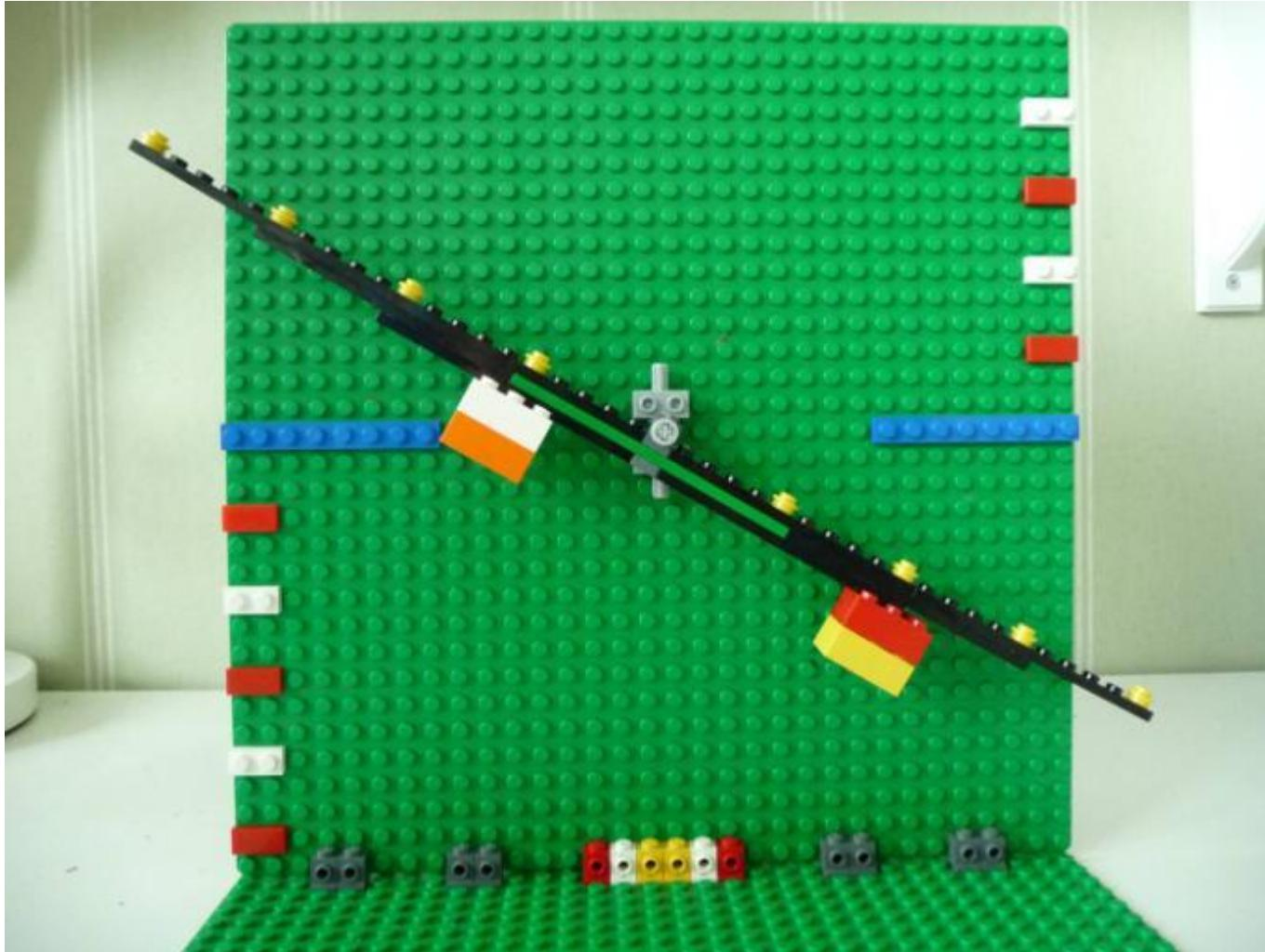
На рычаге я разместила метки через равные расстояния, чтобы измерять длину плечей рычага.
