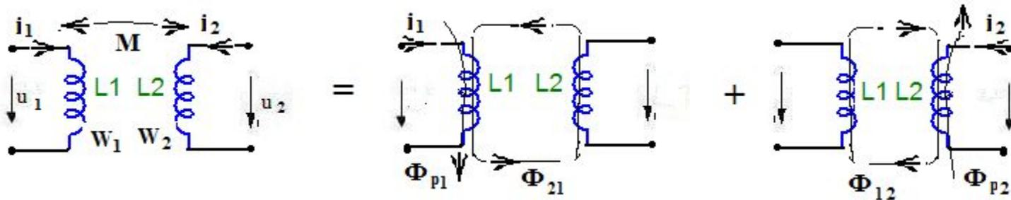
$\Phi_{21}$  - магнитный поток, пронизывающий вторую катушку и создаваемый током первой катушки (поток взаимоиндукции первой катушки);
