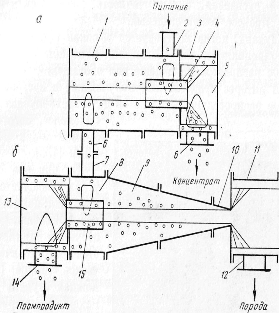
**а — цилиндрический циклон; б — цилиндро-конический циклон: 1 — загрузочная часть; 2 — питающий патрубок; 3 — разгрузочная часть; 4 — сливная насадка; 5 — камера слива; 6 — патрубок слива; 7 — соединительный патрубок; 8 — загрузочная часть; 9 — коническая часть; 10 — нижняя насадка; 11 — породная камера; 12 — породный патрубок; 13 — камера слива; 14 — патрубок слива; 15 — сливная насадка.**
