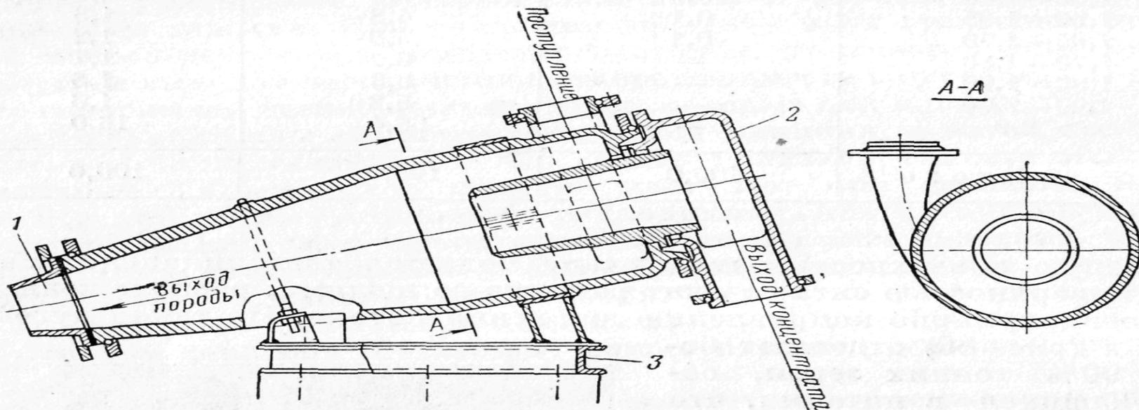
**Гидроциклоны особой конструкции обогащают мелкий уголь в водной среде. В качестве сепаратора использовался каскадный гидроциклон (Крэббса для классификации и сгущения шлама).**
