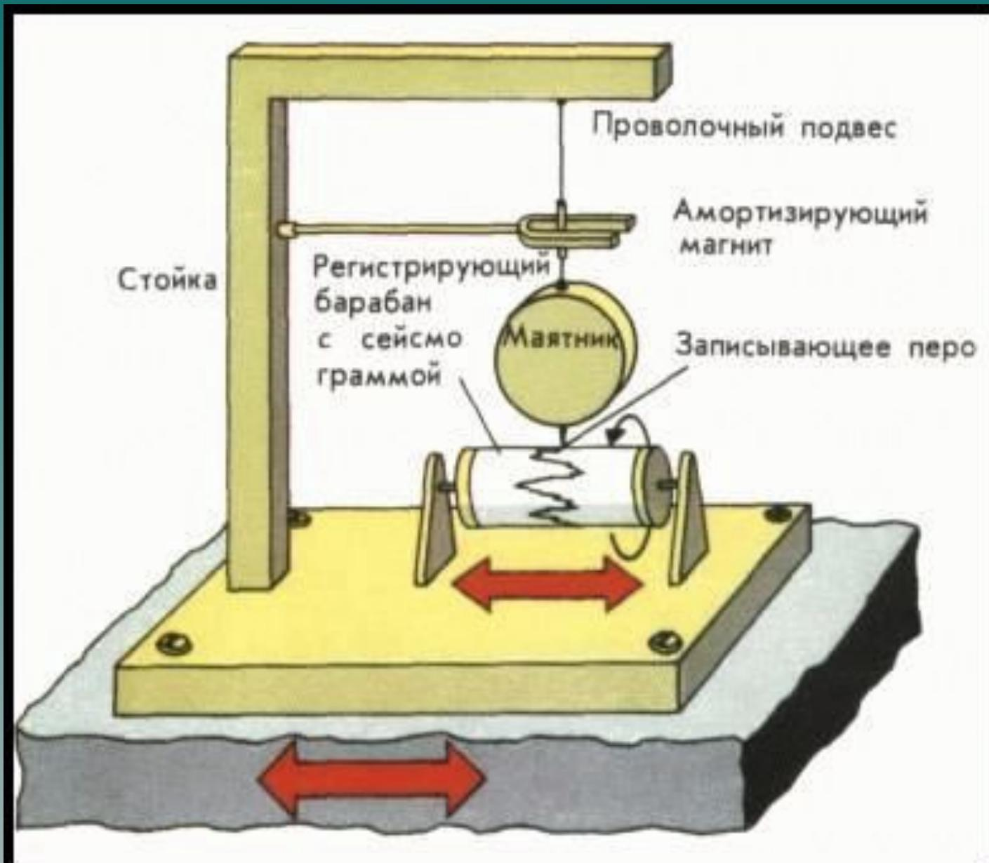
Данный сейсмограф фиксирует вертикальные колебания земли.
