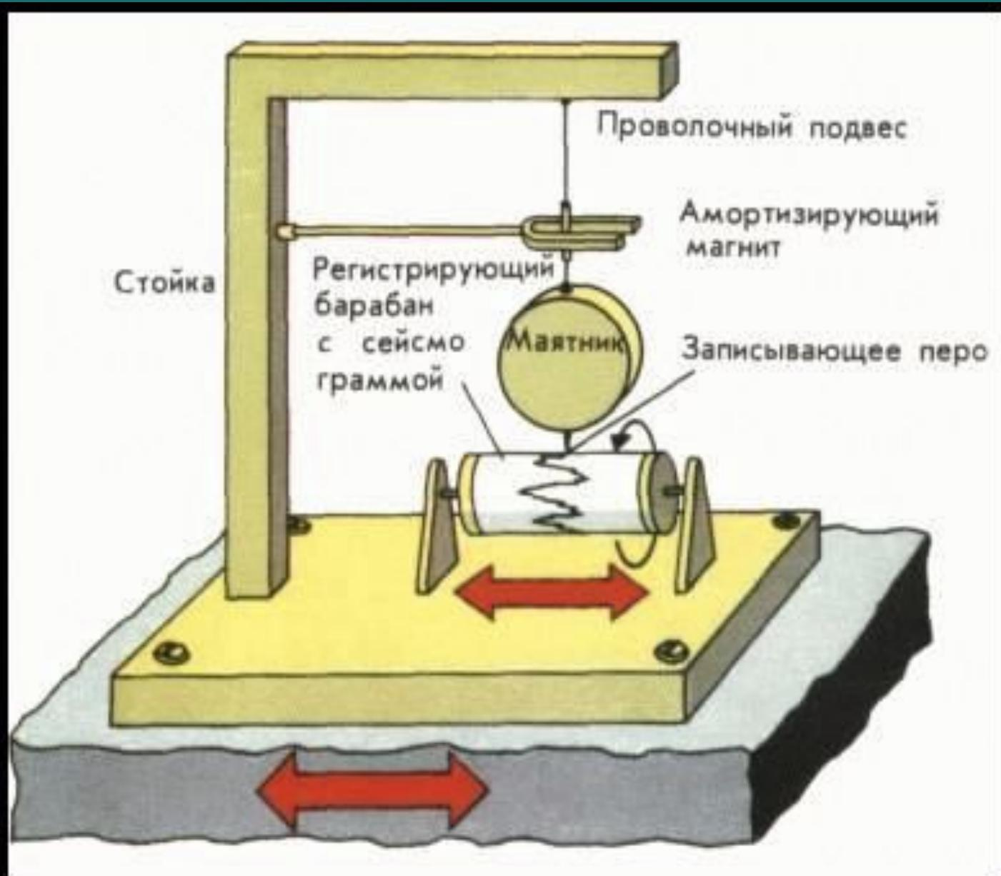
Данный сейсмограф фиксирует вертикальные колебания земли.
