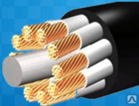
Кабель КГВШ 1 15x1.0 имеет медную жилу (из множества проволок), изоляцию и оболочку из поливинилхлоридного пластика. Кабель данного типа рассчитан на напряжение переменного тока не выше 380 В с частотой 50 Гц.
