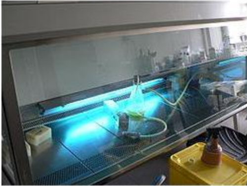
Кварцевая лампа, используемая для стерилизации в лаборатории
