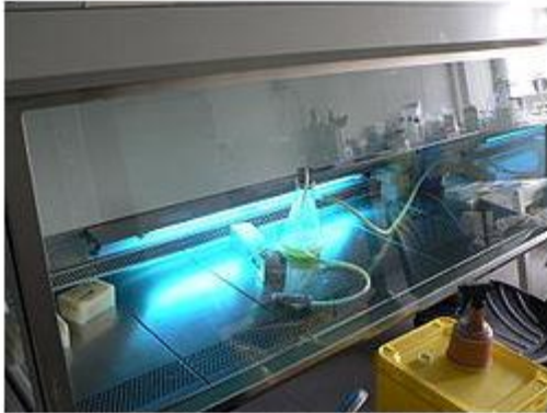
Кварцевая лампа, используемая для стерилизации в лаборатории
