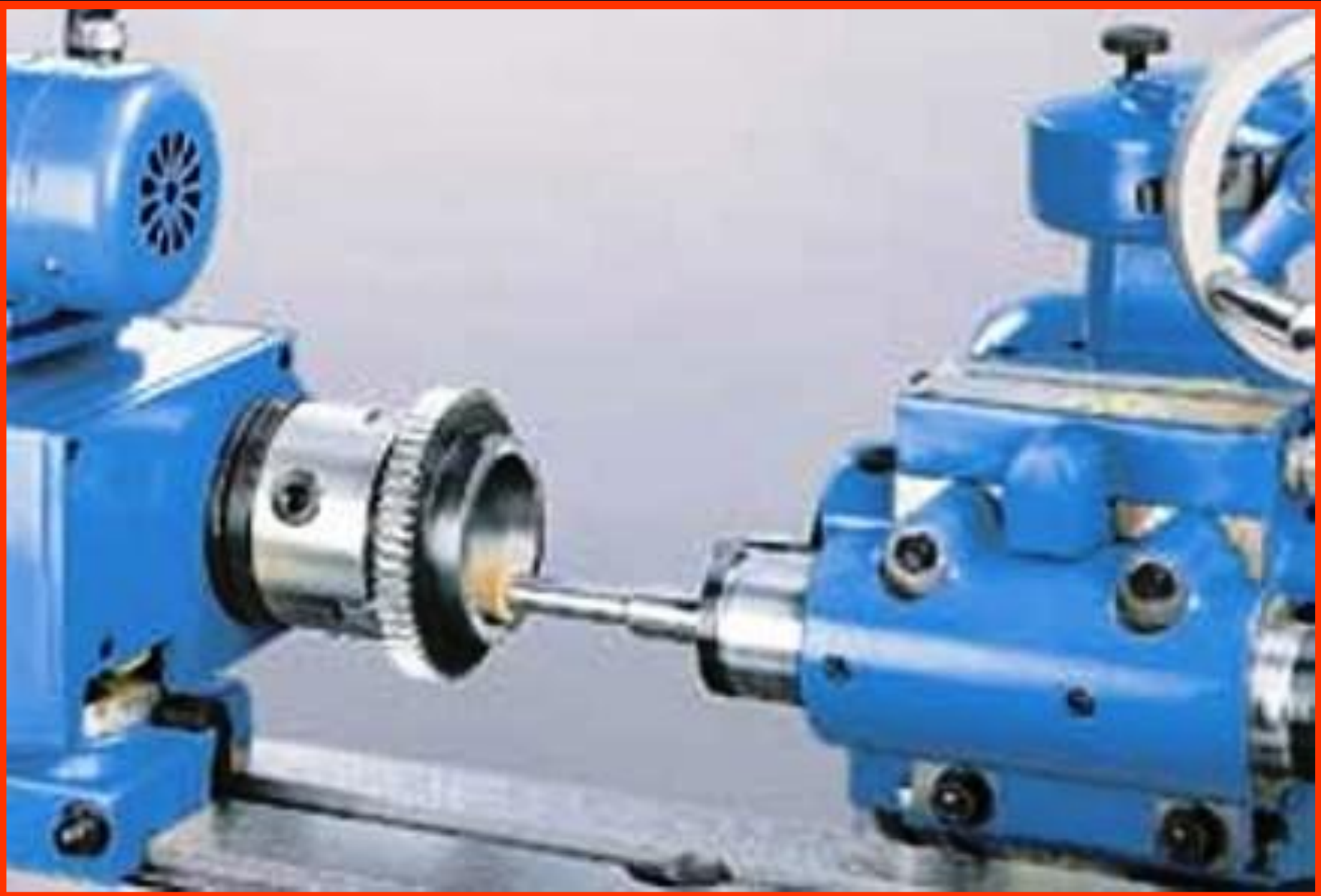
1 – делительная бабка; 2 – деталь; 3 – внутренний шлифовальный круг; 4 – отсос пыли; 5 – наружный шлифовальный круг.
