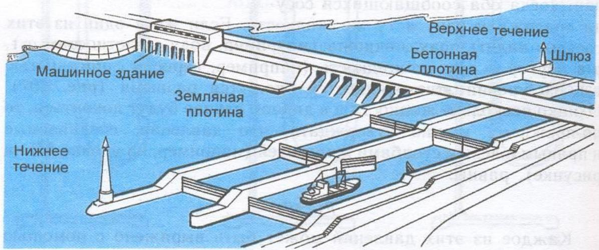
*Действие шлюза – гидротехнического устройства, с помощью которого суда проводят из водного бассейна с одним уровнем воды в другой - с иным уровнем.*
