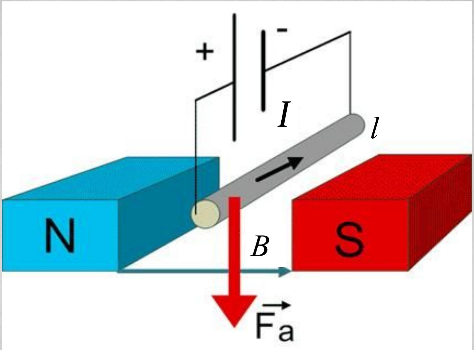
Сила Ампера - это сила, с которой магнитное поле действует на проводник с током.
