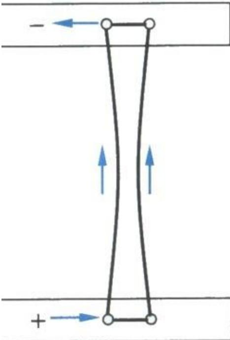
*Два гибких прямых проводника, расположены параллельно друг другу. Оба проводника подсоединенны к источнику тока. При замыкании цепи по проводникам протечёт ток, вследствие чего они взаимодействуют – притягиваются или отталкиваются, в зависимости от направления токов в них.*
