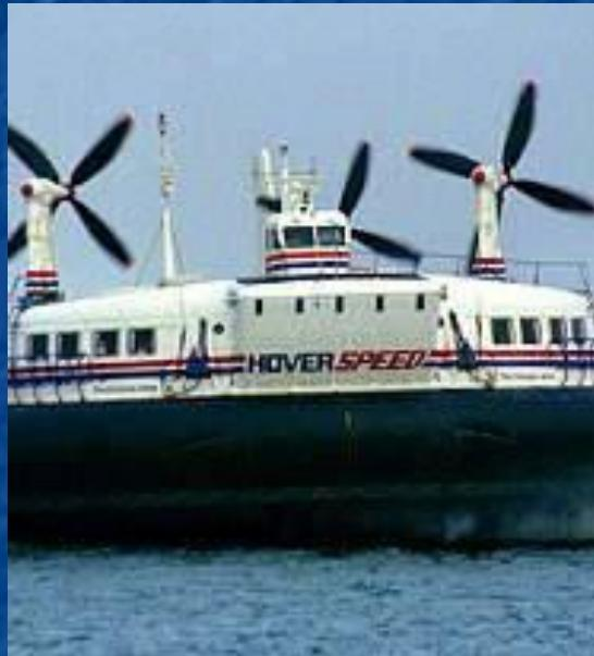
Воздушная подушка – область повышенного давления воздуха между основанием машины и опорной поверхностью, которая препятствует их непосредственному контакту.
