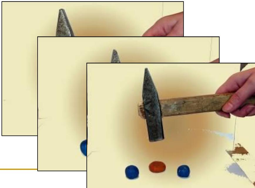
Деформации могут быть **упругими** и **пластическими**.
