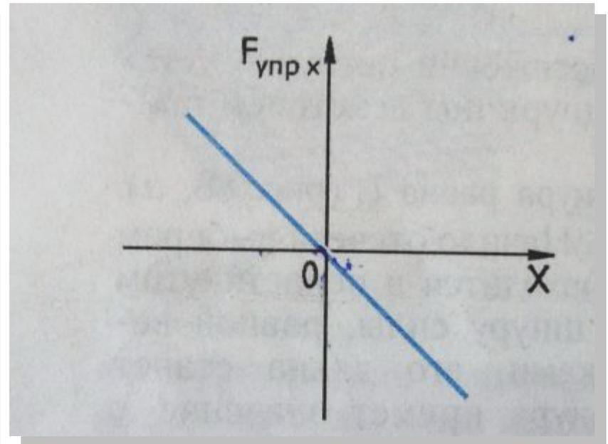
Закон Гука хорошо выполняется только при малых деформациях. При больших деформациях изменение длины перестаёт быть прямо пропорциональным приложенной силе, а при очень больших деформациях тело разрушается.
