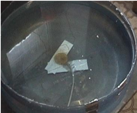
Емкость и пьезоэлемент
