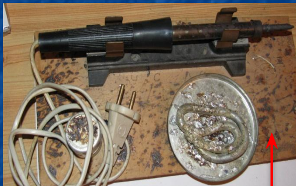
Паяльник (для спаивания соединительных проводов)
