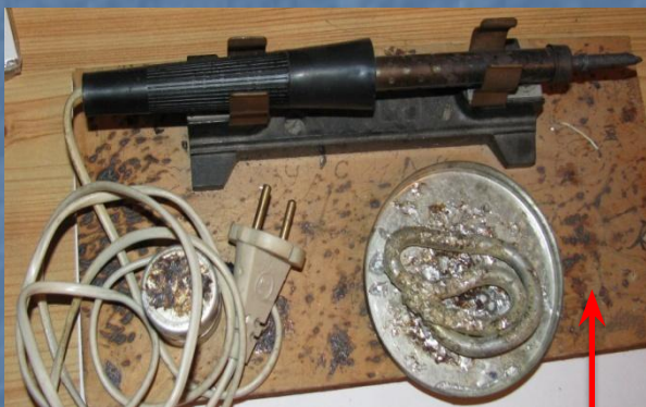
Паяльник (для спаивания соединительных проводов)
