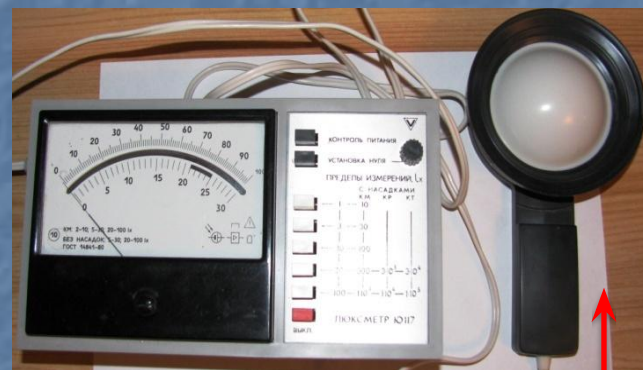
Люксметр - прибор для измерения уровня освещенности, создаваемой лампами освещения и естественным светом
