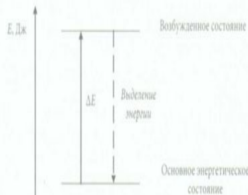
Рис. 3.6. Схематическое изображение процесса эмиссии энергии \Delta E
