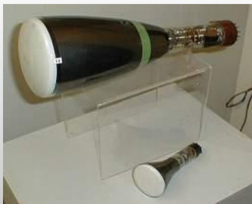
Электронно – лучевая трубка телевизоров
