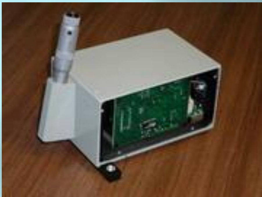
СПЕКТРОГРАФ MS-75 С СИСТЕМОЙ РЕГИСТРАЦИИ НА ШИНУ USB.
