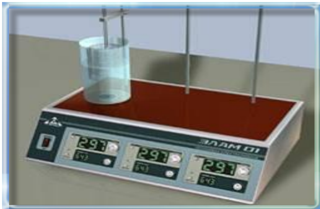
Лабораторная электролизная установка для анализа металлов «ЭЛАМ»
