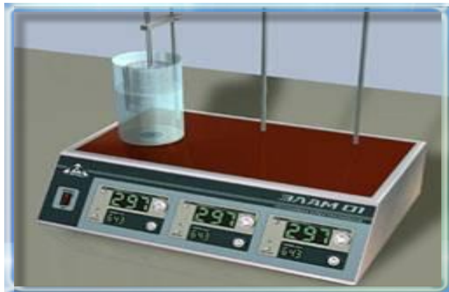
Лабораторная электролизная установка для анализа металлов «ЭЛАМ»
