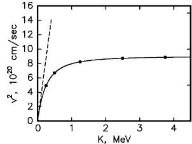
В этом опыте электроны разгонялись в ускорителе Ван-де-Граафа, а затем двигались с постоянной скоростью через пространство, свободное от электрического поля. Время их полета на известном расстоянии АВ, а следовательно и их скорость, измерялись непосредственно, а кинетическая энергия (переходящая в тепло при ударе о мишень в конце пути) измерялась с помощью термопары.
