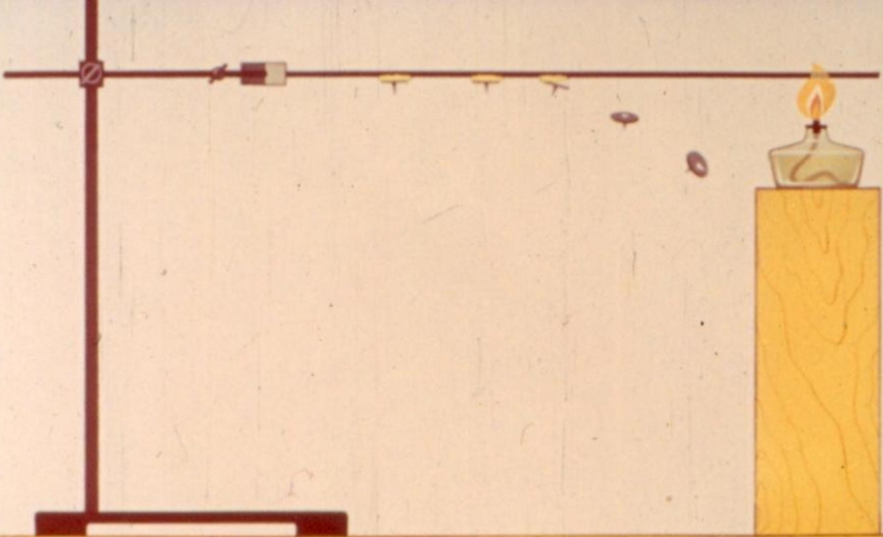
В классе вы имели возможность провести этот опыт: теплота от спиртовки передается вначале одному концу проволоки, затем постепенно нагревается вся проволока. И знаете, что такая передача теплоты называется теплопроводностью.
