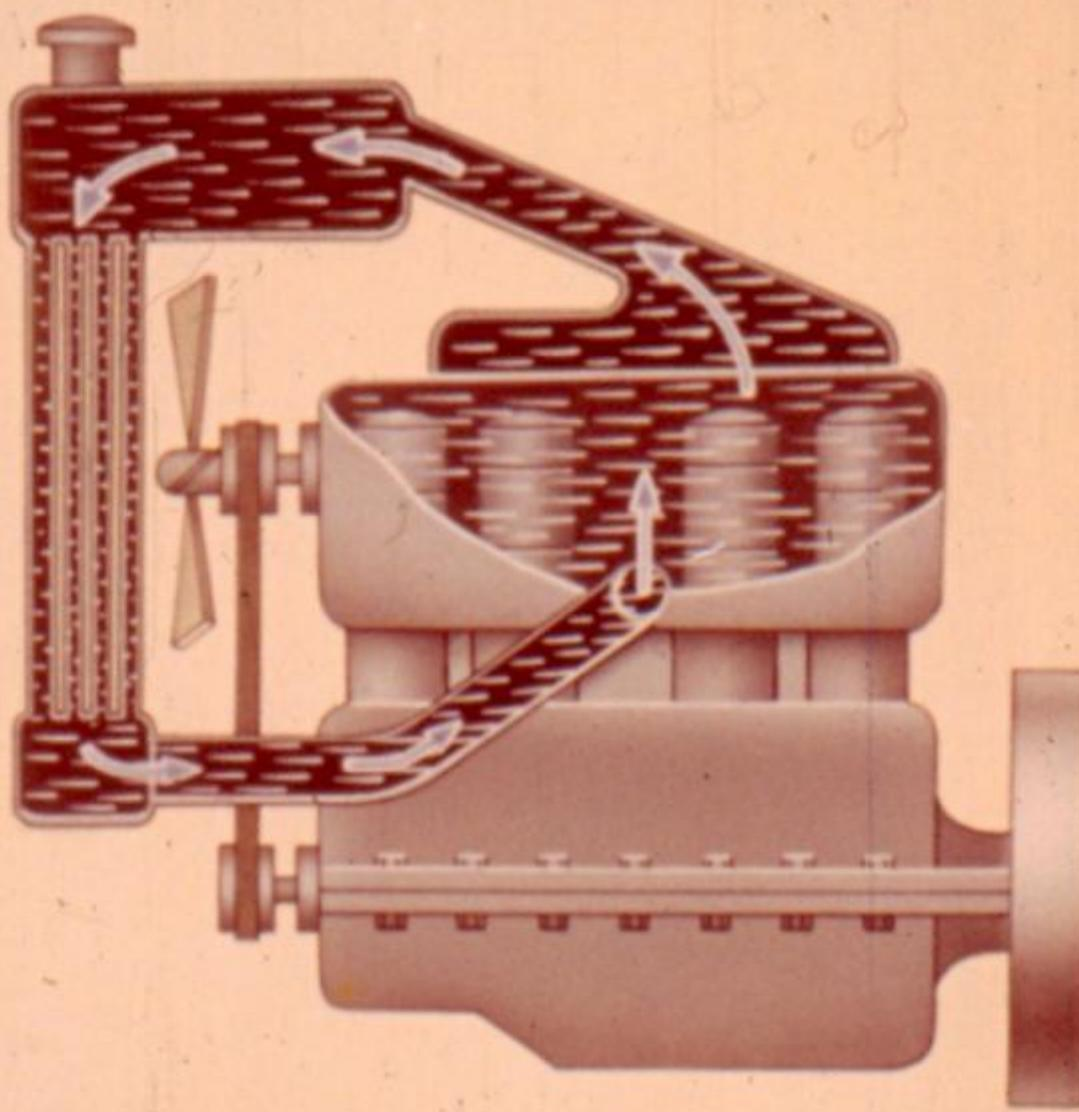
Как осуществляется охлаждение двигателя (при работе двигателей температура газов в цилиндрах достигает 1800 – 2000°С)?
