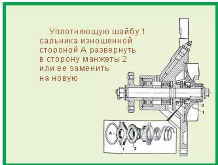
Рис. 6- Перестановка изношенной детали. ¶
