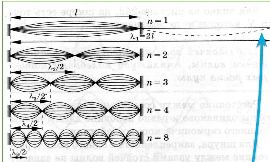
На длине шнура, закрепленного на концах, укладывается целое число  $n$  полуволн поперечных стоячих волн.
