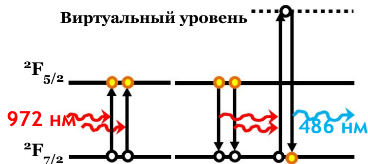
Механизм кооперативной люминесценции ионов Yb^{3+} в микрокристаллических трубках ZrO_2 -3мол.% Y_2O_3 -2мол.% Yb_2O_3 при возбуждении 972 нм
