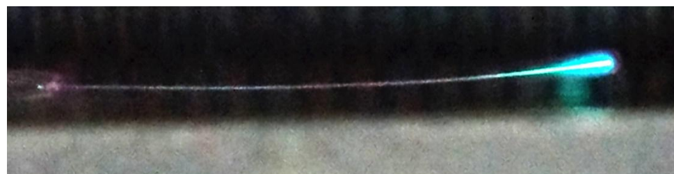
Свечение микрокристаллической трубки ZrO_2 -3мол.% Y_2O_3 -2мол.% Yb_2O_3 , наблюдаемое при воздействии сфокусированного лазерного пучка с длиной волны 972 нм
