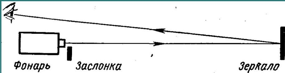
На рисунке показана схема опыта, с помощью которого Галилей предлагал измерить скорость света. Открывая заслонку фонаря, нужно было определить, через сколько времени вернется свет, отразившись от зеркала.
