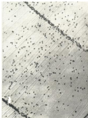
Скопление дислокаций на межзеренных границах
