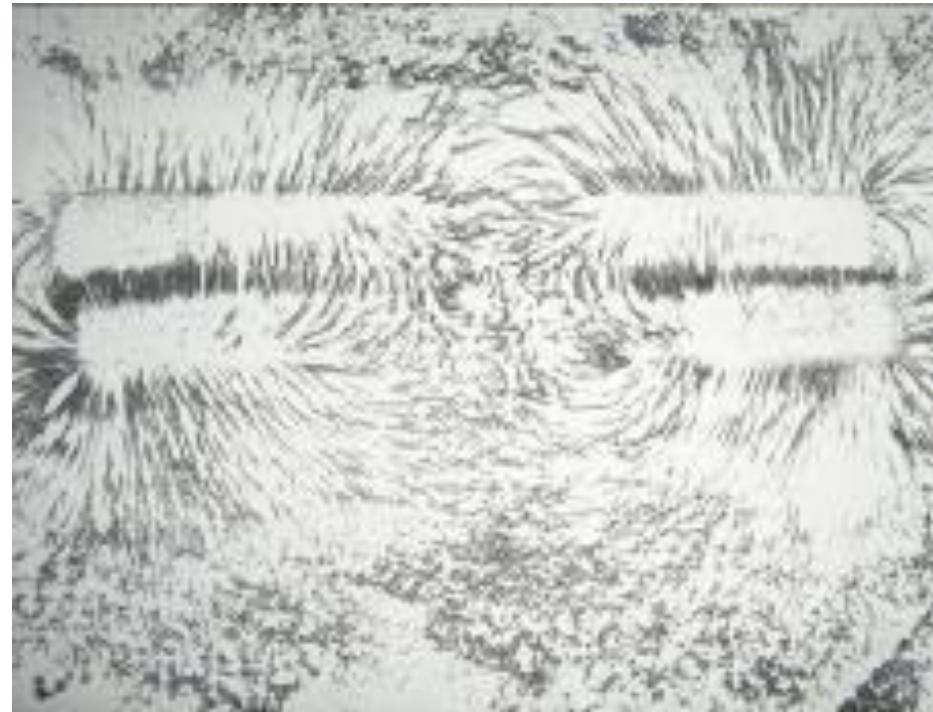
Вывод: такое магнитное поле на расстоянии 2–3 см ослабевает: железные опилки расположены хаотично, поэтому четкой картины мы не наблюдаем. Можно сказать, что магнитное поле одного магнита компенсирует магнитное поле другого.
