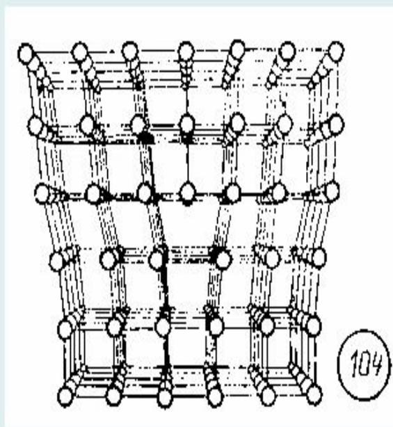
Деформация и разрушение кристалла с линейным дефектом облегчаются потому, что вместо одновременного разрыва всех связей между атомами двух плоскостей становится возможным поочередный разрыв небольшого числа связей между атомами с постепенным перемещением дефекта в кристалле.
