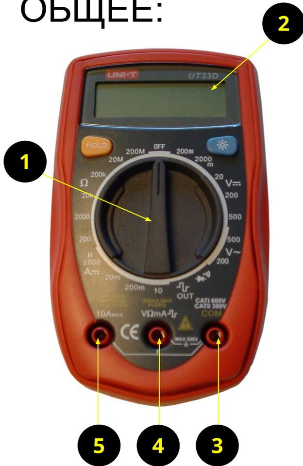
**1. Функции** – для выбора функции и диапазона измерений
