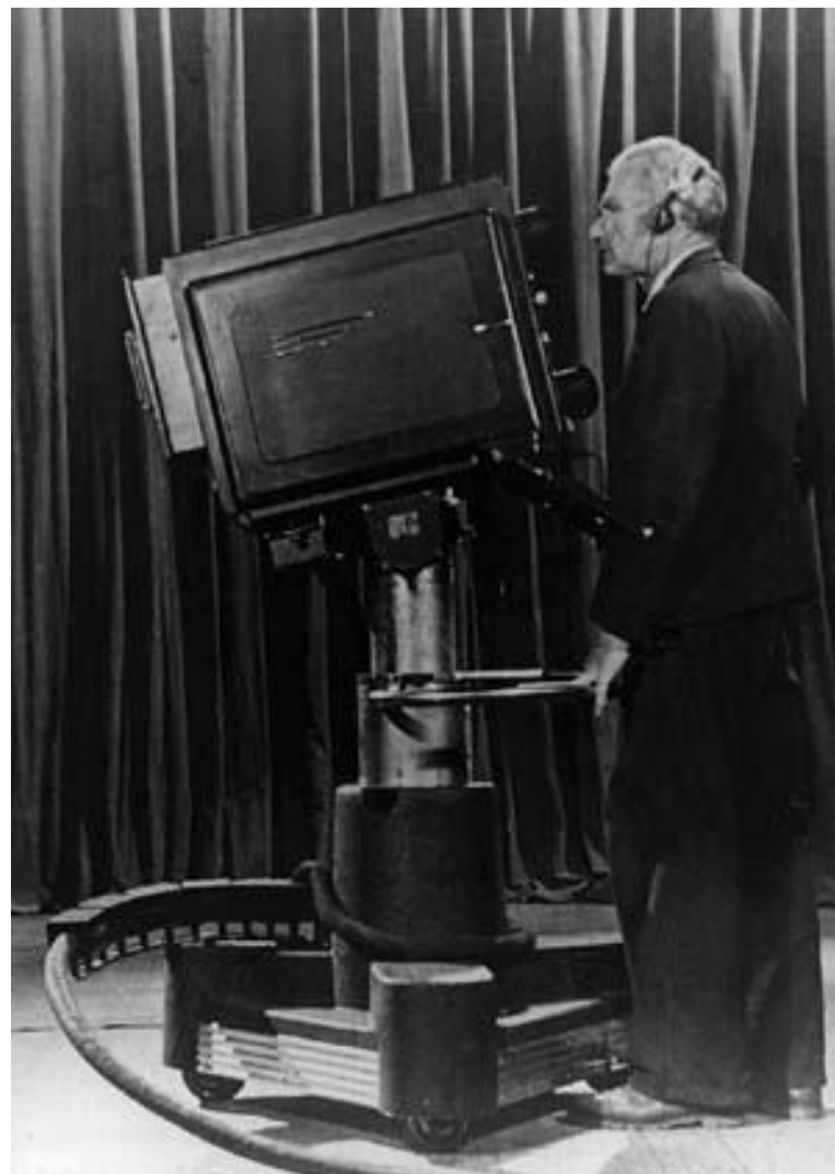
Телевизионная камера на иконоскопе. Архив НИИТ
