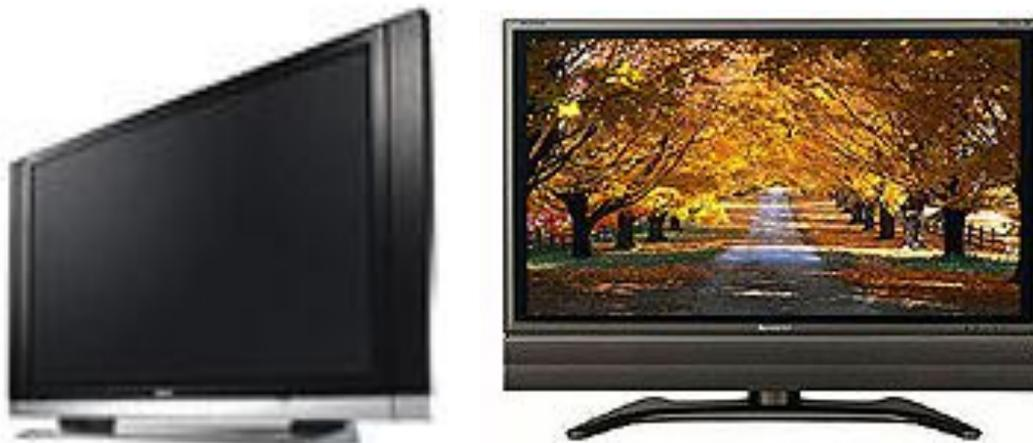
**Экран состоит из двух стеклянных панелей, пространство между которыми заполнено газом. Там же, внутри, имеется сетка из электрических проводов. Ток превращает газ в плазму, которая и вызывает свечение флюоресцирующих элементов. Изображение создается из сотен тысяч таких элементов, окрашенных в разные цвета. Процессор с огромной частотой раздает «задания» для каждого пикселя, и таким образом создается «картинка».**
