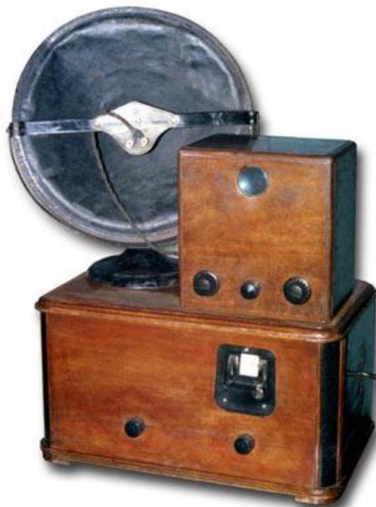
**Прибор приемной аппаратуры с механической разверткой.
