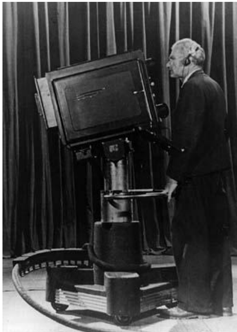
Телевизионная камера на иконоскопе. Архив НИИТ
