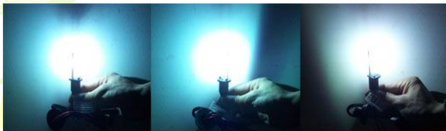
12000K 10000K 8000K Примеры цветовых температур ксеноновых ламп 3000K 4300K 6000K
