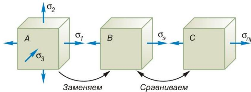
По этой гипотезе критерий перехода от исследуемого напряженного состояния **A** к эквивалентному состоянию **B** основан на том, что предельное напряженное состояние возникает при некотором значении потенциальной энергии, накапливаемой элементом конструкции за счет изменения только его формы. Поэтому пятая гипотеза иначе называется *гипотезой энергии формоизменения*.
