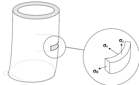
Предельным напряжением для пластичного материала является предел текучести  $\sigma_t$ , а для хрупкого – предел прочности  $\sigma_b$ .
