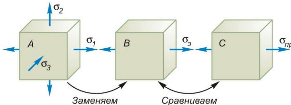
Переход от исследуемого напряженного состояния **A** к эквивалентному напряженному состоянию **B** осуществляют на основе критерия, предопределяющего возникновение предельного состояния, а затем эквивалентное напряженное состояние **B** сравнивают с подобным ему предельным напряженным состоянием **C** и определяют коэффициент запаса:
