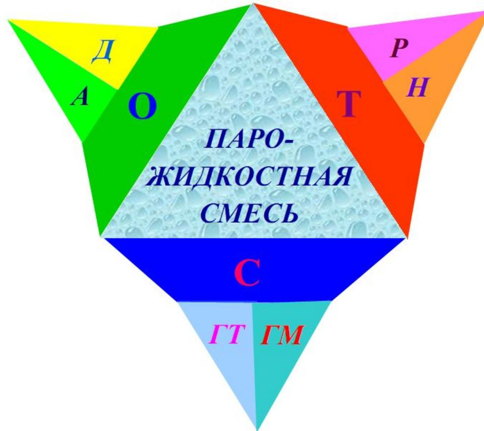
Классификация парожидкостных потоков: по структуре (С) – гомогенные (ГМ), гетерогенные (ГТ); по наличию теплообмена с поверхностью канала (О) – адиабатные (А), диабатные (Д); по термодинамическим параметрам (Т) – равновесные (Р), неравновесные (Н).
