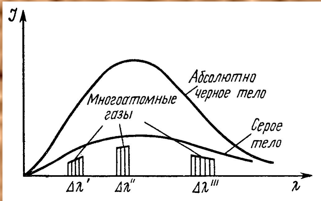
Рис. 15.10. Спектры излучения многоатомных газов и твердого тела
