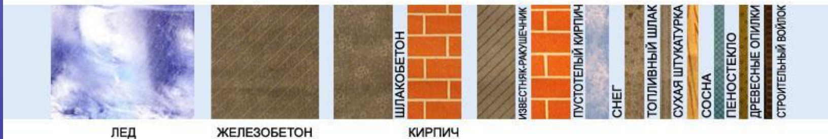
ШКАЛА ТОЛЩИНЫ МАТЕРИАЛОВ ПРИ ОДИНАКОВОЙ ТЕПЛОПРОВОДНОСТИ
