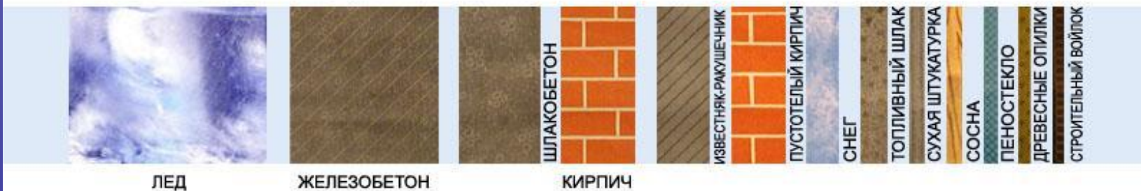
ШКАЛА ТОЛЩИНЫ МАТЕРИАЛОВ ПРИ ОДИНАКОВОЙ ТЕПЛОПРОВОДНОСТИ
