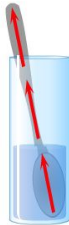
Передача тепла от одной части ложки к другой
