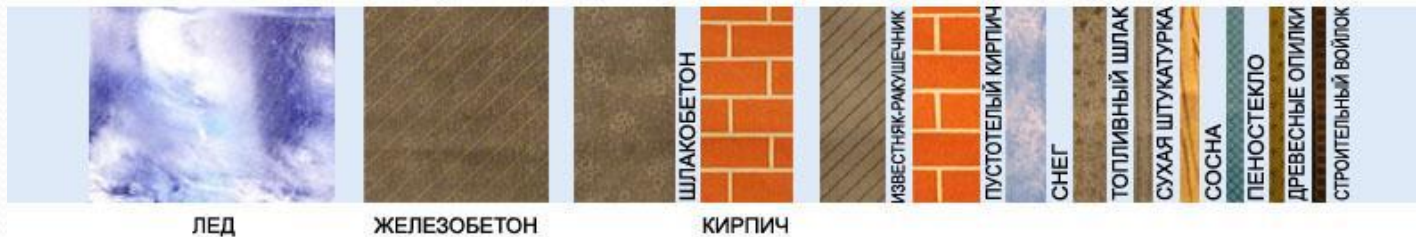
ШКАЛА ТОЛЩИНЫ МАТЕРИАЛОВ ПРИ ОДИНАКОВОЙ ТЕПЛОПРОВОДНОСТИ
