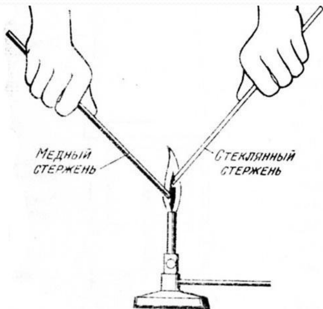
Различная теплопроводность меди и стекла
