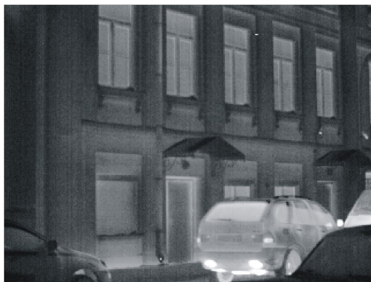
Рис. Тепловое изображение. Получено в спектральном диапазоне 8...12 мкм наблюдательным прибором.
