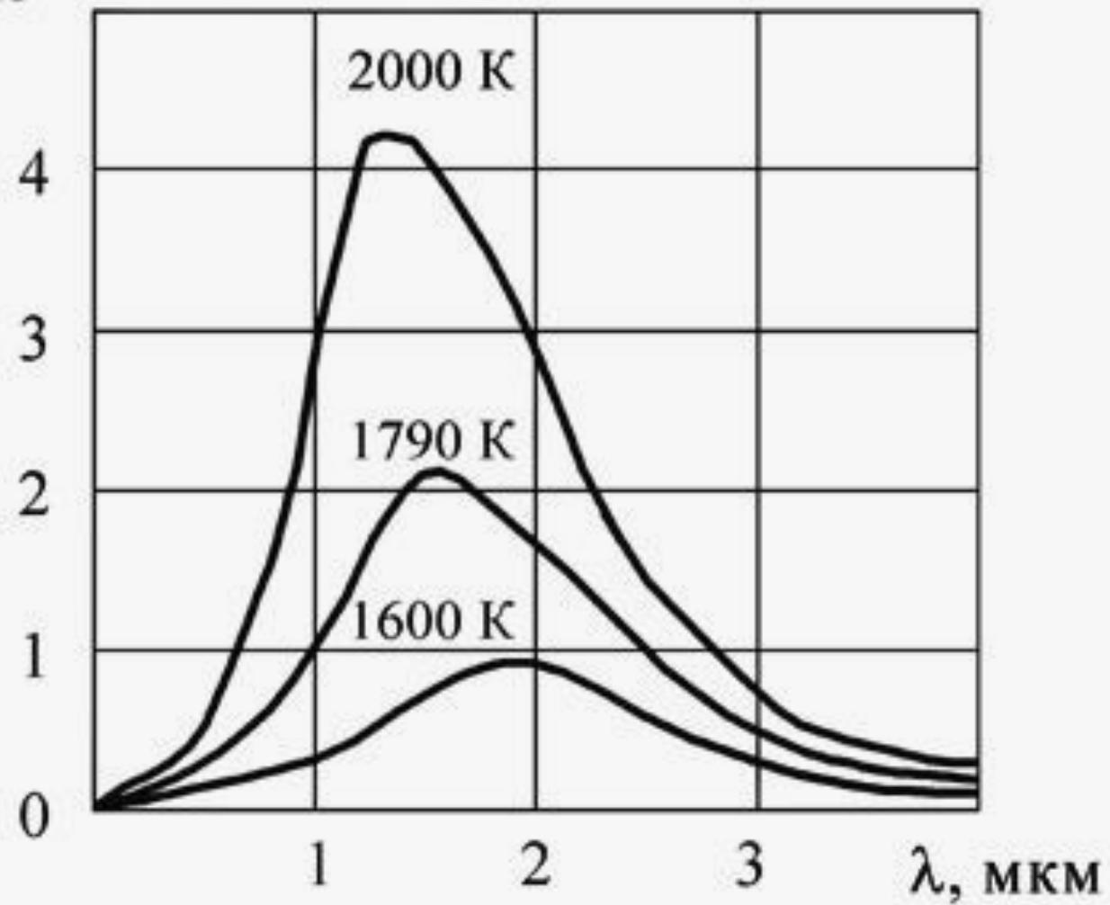
Рис. 4. Спектральная испускательная способность абсолютно черного тела
