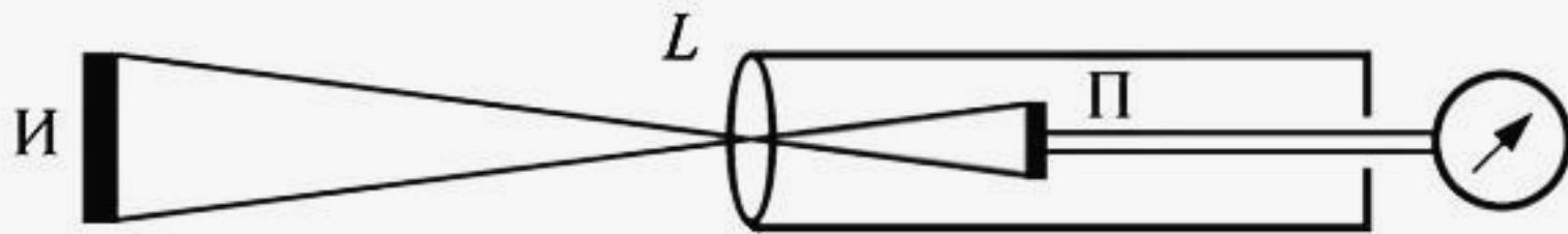
Рис. 6. Устройство радиационного пирометра
