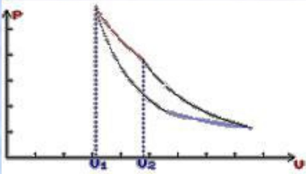
$$\frac{T_1 - T_2}{T_1} \cdot 100\%$$
