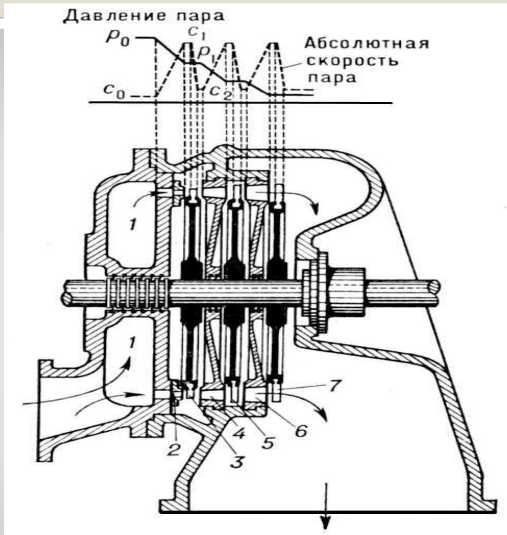
Схематический продольный разрез активной турбины с тремя ступенями давления: 1 — кольцевая камера свежего пара; 2 — сопла первой ступени; 3 — рабочие лопатки первой ступени; 4 — сопла второй ступени; 5 — рабочие лопатки второй ступени; 6 — сопла третьей ступени; 7 — рабочие лопатки третьей ступени.
