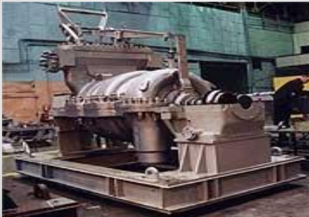
**Паровая турбина – первичный паровой двигатель с вращательным движением рабочего органа — ротора и непрерывным рабочим процессом; служит для преобразования тепловой энергии пара водяного в механическую работу.**
