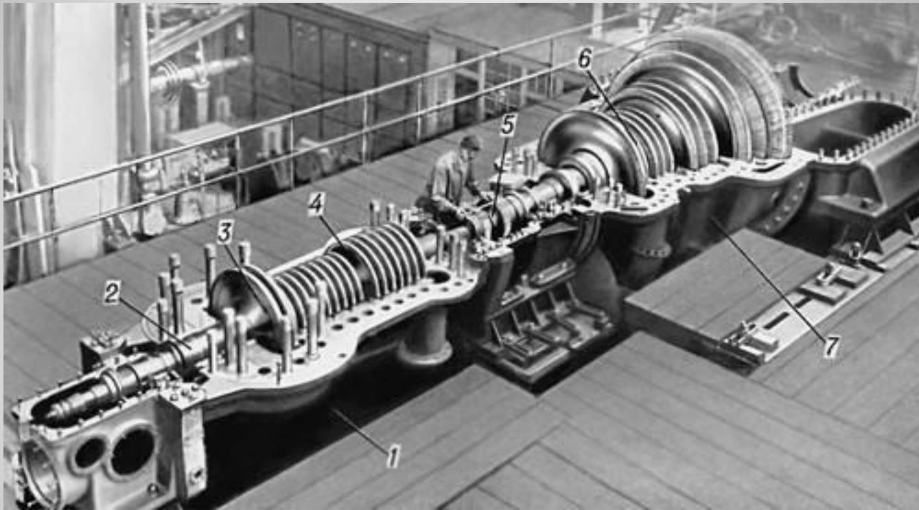
**Двухкорпусная паровая турбина (со снятыми крышками):**
